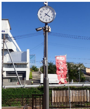
YOT-TOKO入口に設置したWBGT計（支柱中部）
