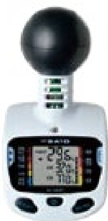
写真1 今回使用した簡易WBGT計 写真撮影 関東地方環境事務所
